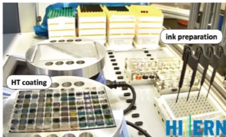
[그림 16] 하버드대 태양전지용 유기물 활성층 합성을 위한 자율화 실험실 HW
